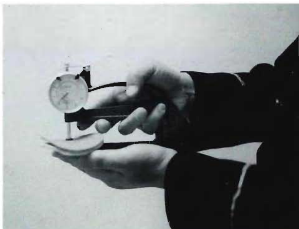
写真4 各種服地の厚さの測定状況
