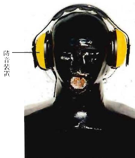
写真9 防音装置の取付け状況
