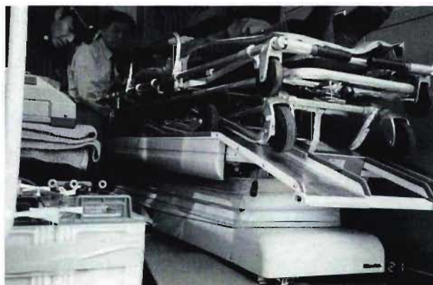
写真9 防振架台とストレッチャー
