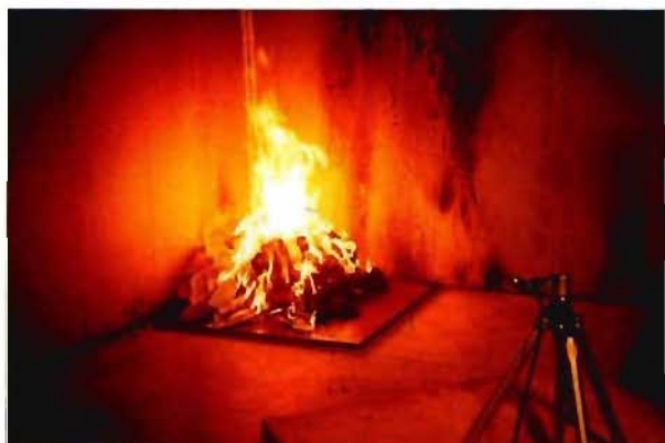
写真4 紙類の燃焼状況
