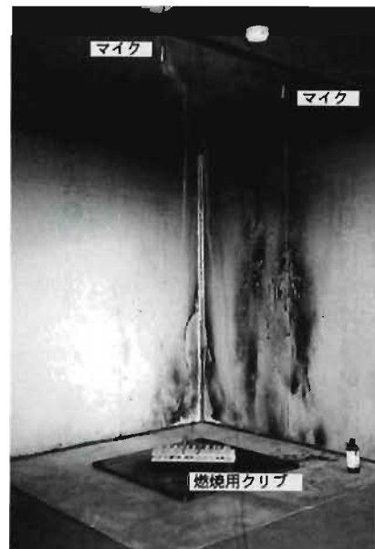
写真8 試験器の性能確認実験
