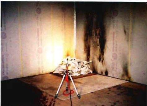
写真5 紙の燃焼音の測定状況
