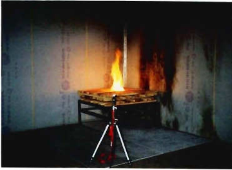
写真2 クリブの燃焼音の測定状況
