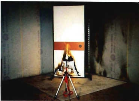
写真4 段ボール襖の燃焼音の測定状況
