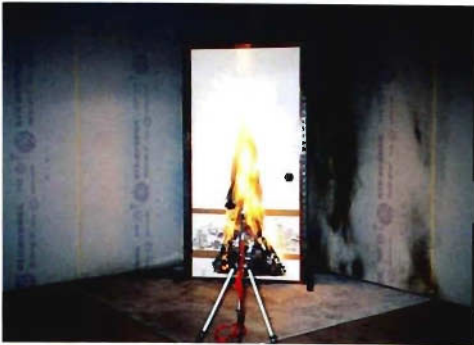
写真3 和襖の燃焼音の測定状況
