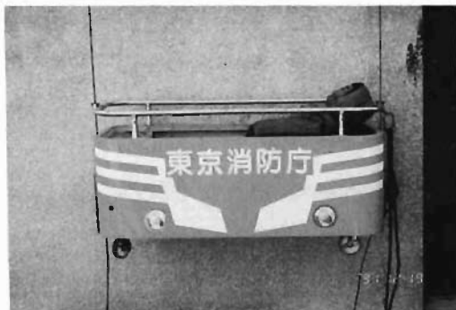
写真1 昇降バケットの全景
