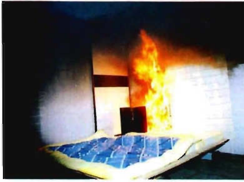
写真9 住宅モデル火災(燃焼中の状況)
