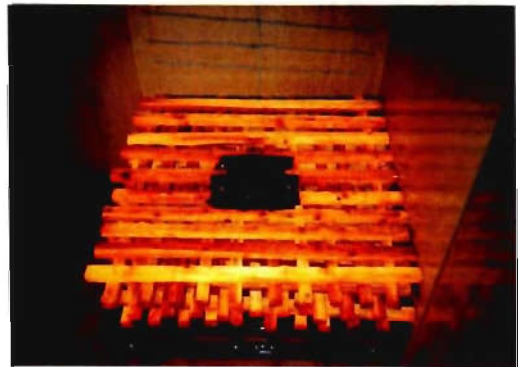
写真7 クリブ火災実験(燃焼後の状況)
