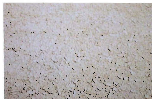
写真7 供試吹きつけ壁 (凹凸1~2mm)
