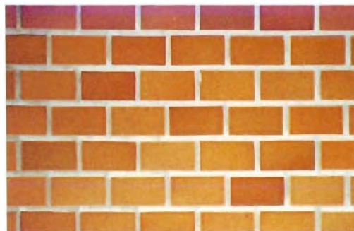
写真6 供試タイル壁 (105×60mm, 目地幅12mm, 深さ1mm)
