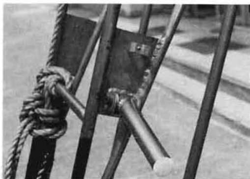
写真7 取手の取付け状況
