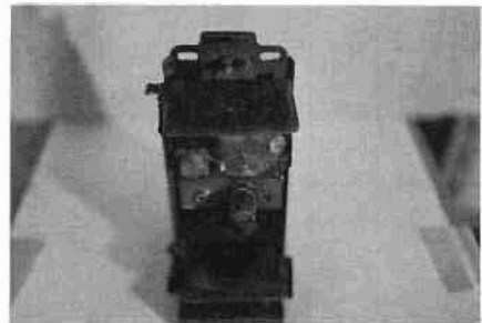
写真1 錆等により全く作動しなかったセンサー
