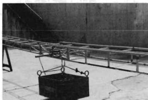
写真5 静ひずみ測定状況(水平)
