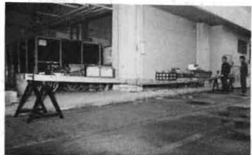
写真1 アルミ合金製三連はしごのひずみ測定 (荷重量60kg×3点)
