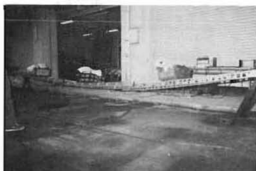
写真4 アルミ合金製三連はしごに120kg×3点(破壊荷重)を加えた状況
