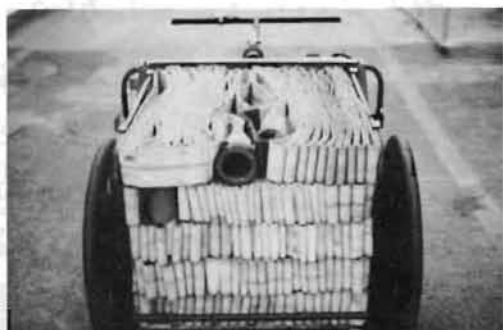
写真4 65mmホース積載状況
