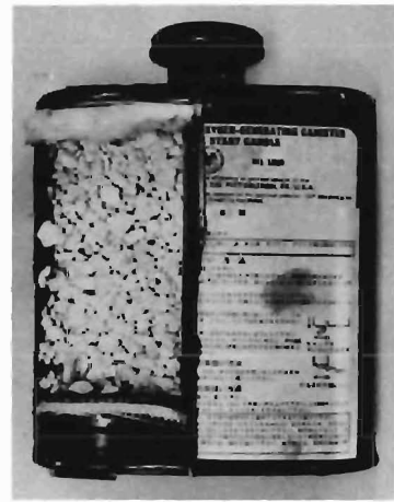
写真1 発生缶の構造
