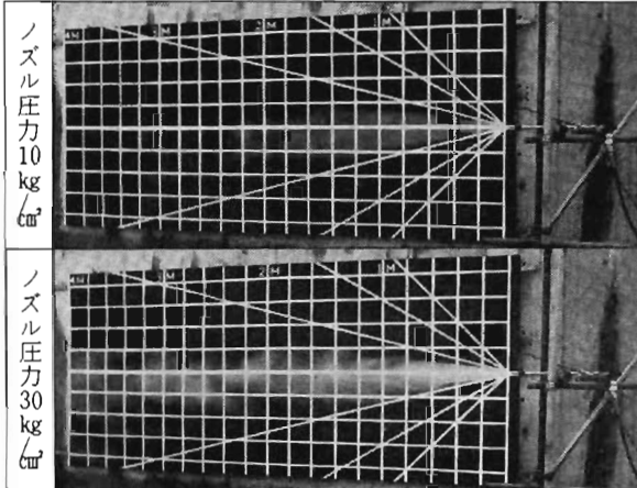
写真5 スパイラルノズルの噴霧放射形状
