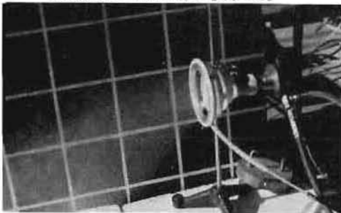
写真4 静電噴霧ノズルの放射状況 (圧力20kg/cm 2 電圧50kV)
