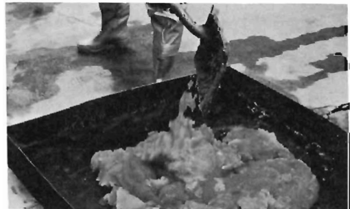
写真6 ゲル化された水をスコップで処理しているところ
