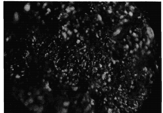
写真一 2 (800℃の炎を5秒間接炎後の防火服地の顕微鏡写真) (×25倍)
