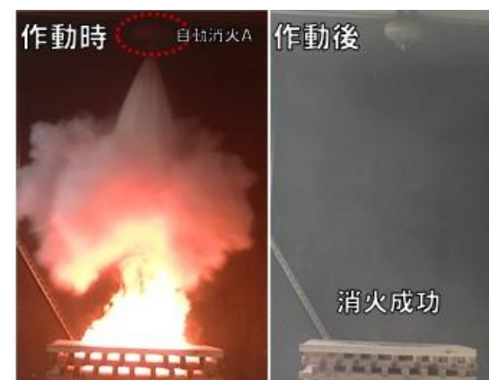
図 4 自動消火 A の消火状況
