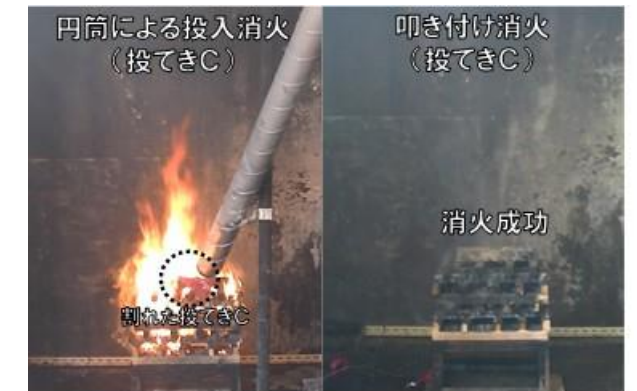
図 2 投てき C の消火状況
