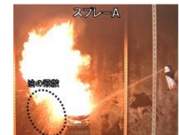
図 3 油火災火源のスプレー消火状況
