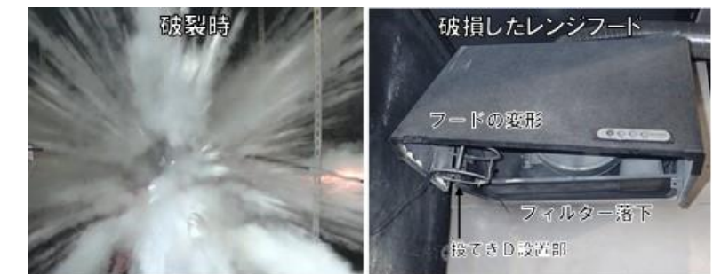
図 5 投てき D の破裂状況
