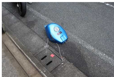
写真3 燃料タンクからの流出状況
