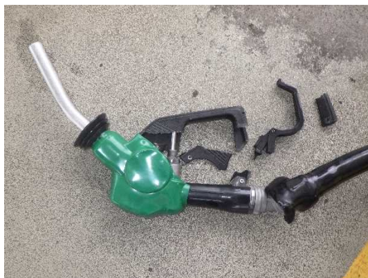
衝突した給油ノズル
