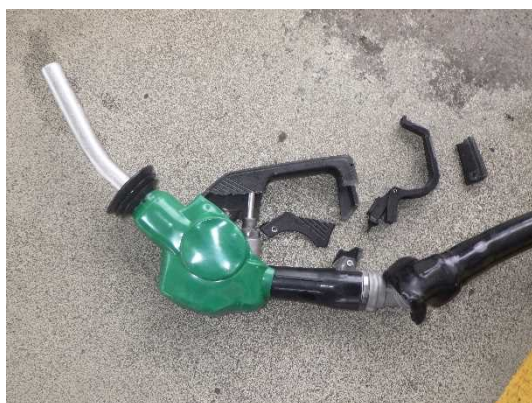
破損した給油ノズル
