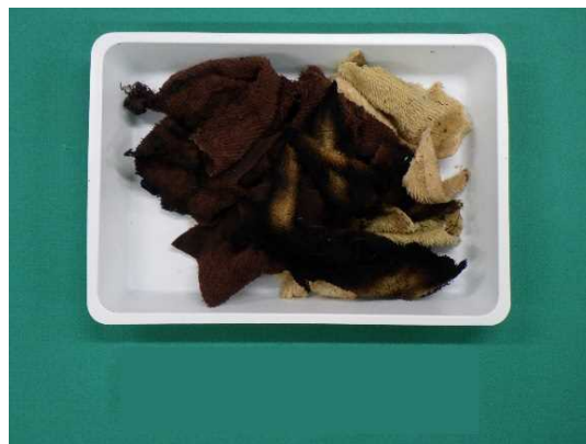
写真 10-2 焼損したタオルの状況
