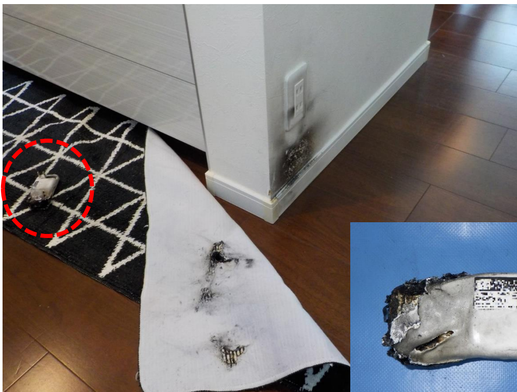
⑩充電中のモバイルバッテリーが 電池内部で短絡して出火した火災（9月）
