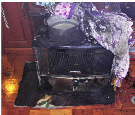
写真 8-1 石油ストーブの焼損状況
