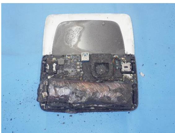
写真 6-5 モバイルパソコンの焼損状況
