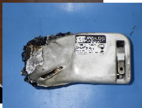
⑩充電中のモバイルバッテリーが 電池内部で短絡して出火した火災（9月）
