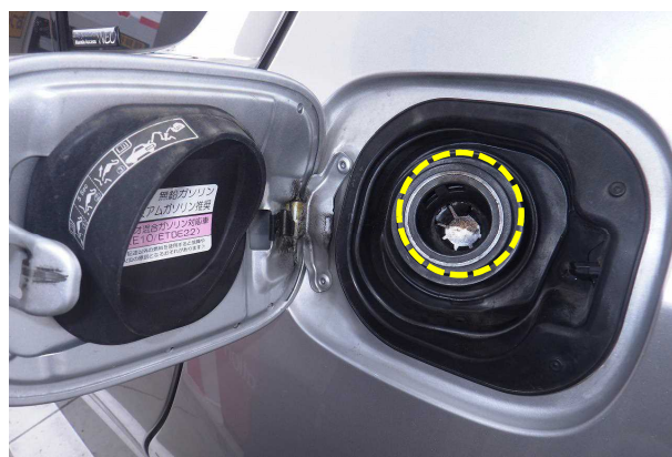
写真 28-4 給油口の焼損状況
