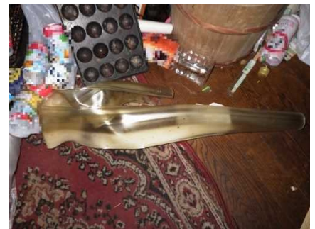
写真 11-7 溶融した照明カバー
