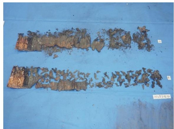
写真 6-6 焼損したバッテリーの状況
