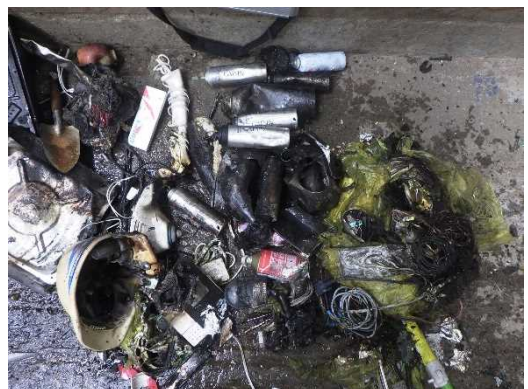
写真 11-5 焼損したスプレー缶の状況
