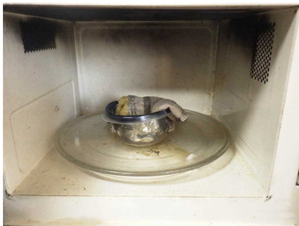
写真 15-4 焼損した食品の状況
