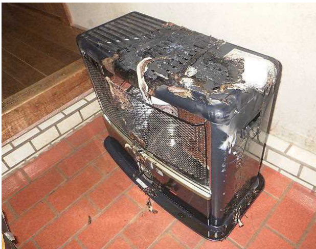
写真 8-3 焼損した石油ストーブの状況
