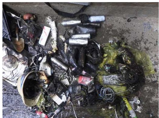
写真 11-5 焼損したスプレー缶の状況
