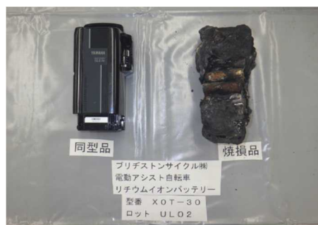
写真 13-2 焼損したバッテリーの状況
