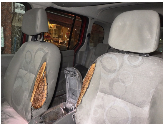
写真 4-3 焼損したフロントシートの状況
