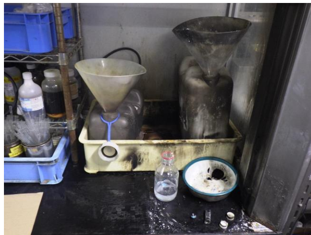
写真 23-4 焼損した廃液タンクの状況
