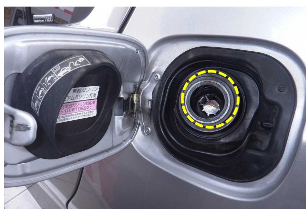
写真 28-4 給油口の焼損状況
