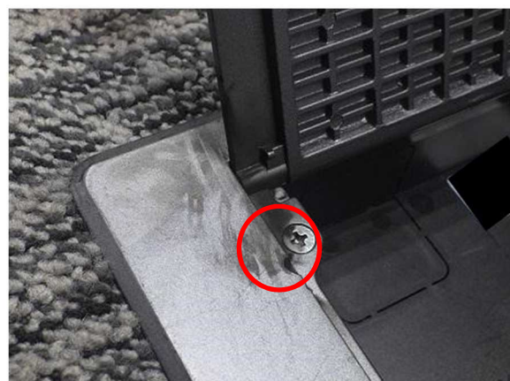
写真 26-4 フロアコンセント付近の焼損状況
