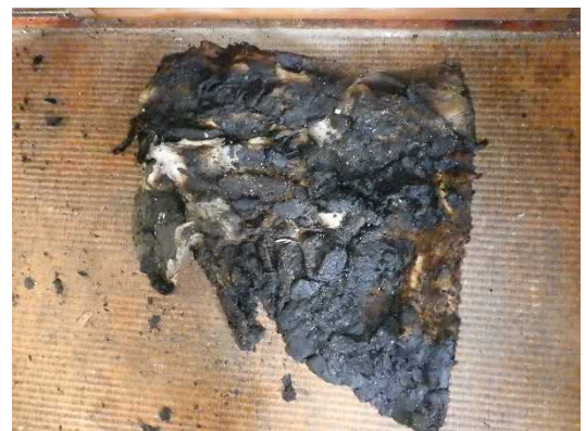
写真 14-5 座布団の焼損状況
