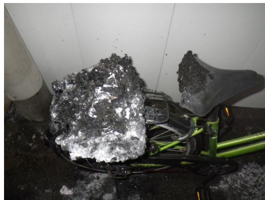
写真 1-2 自転車の焼損箇所
