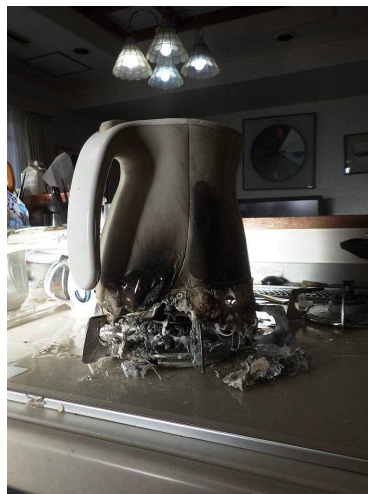
写真 15-2 焼損した電気ケトルの状況
