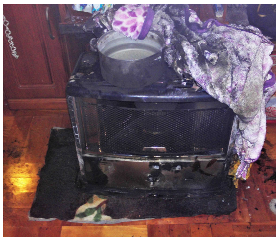
写真 8-1 石油ストーブの焼損状況
