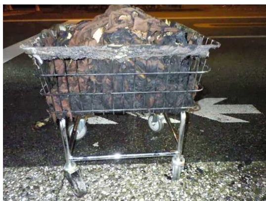
写真10-1 洗濯物の焼損状況
