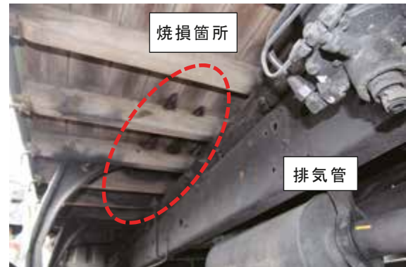
写真 30-1 荷台下部の焼損状況
