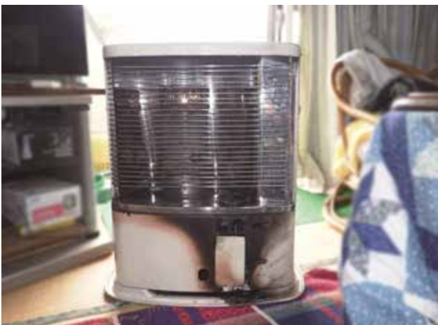
写真 8-1 石油ストーブの焼損状況
