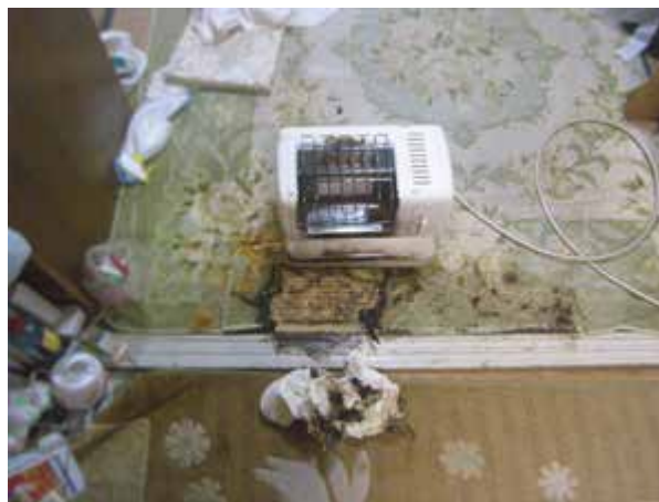
写真 19-2 ガストーブ周辺の焼損状況
