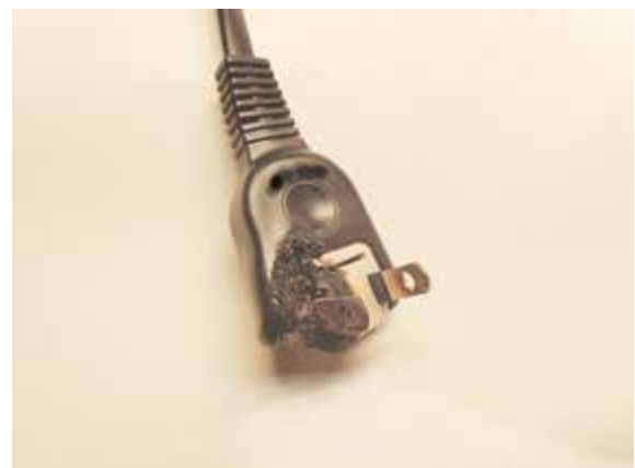
写真 6-2 テーブルタップの差込みプラグ（可動部分）の焼損状況
