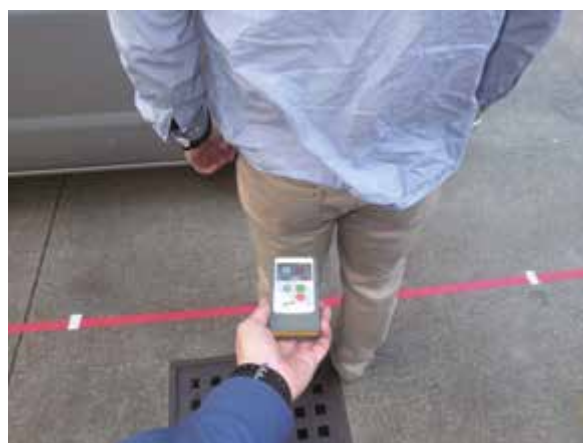
写真 29-5 帯電測定の状態
