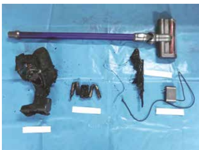
写真 6-3 焼損したコードレス掃除機の状況
