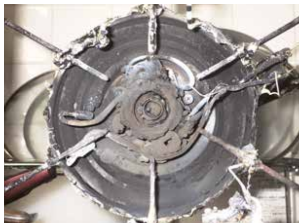
写真 15-2 焼損した電気ケトル（底面）の状況
