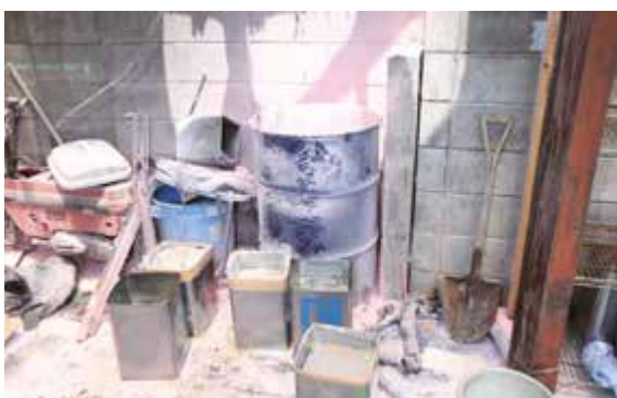
写真 10-3 出火した廃油タンク
