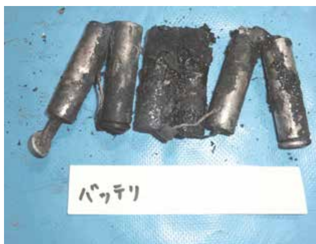
写真 6-4 焼損した純正品でない バッテリーパックの状況
