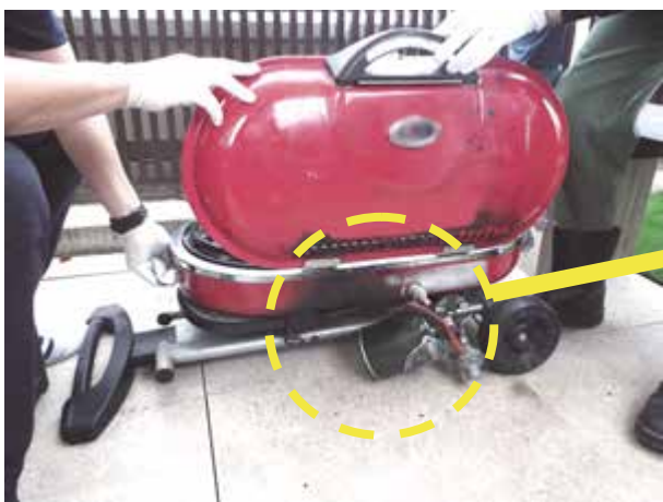
写真 7-3 バーベキューグリルの焼損状況
