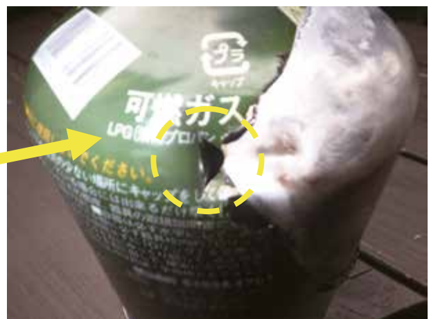
写真 7-4 カートリッジの破損状況
