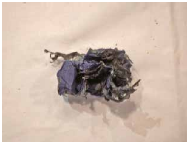
写真 20-2 焼損した紙ナプキン
