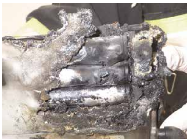
写真 13-2 ノートパソコン用の バッテリーパック焼損状況
