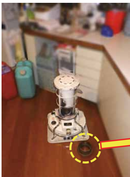
写真 8-3 石油ストーブの状況 (芯外筒が外れている)
