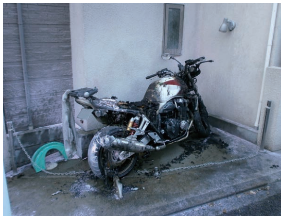
写真 1-1 焼損したオートバイ
