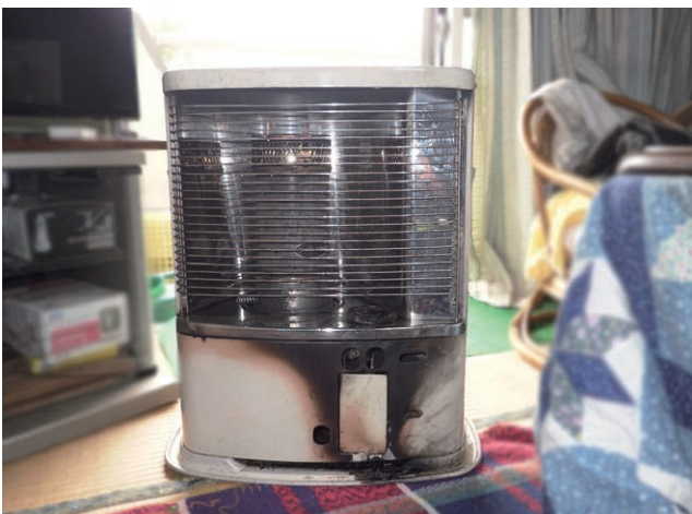
写真 8-1 石油ストーブの焼損状況
