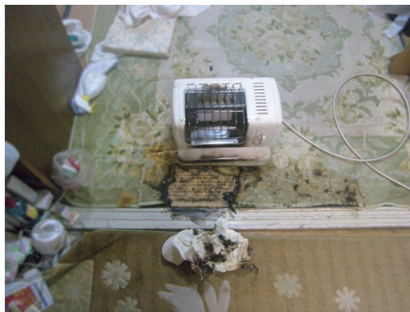
写真 19-2 ガストーブ周辺の焼損状況
