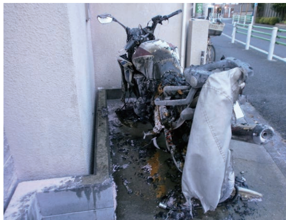
写真 1-2 焼損したボディカバー
