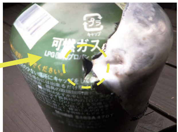
写真 7-4 カートリッジの破損状況
