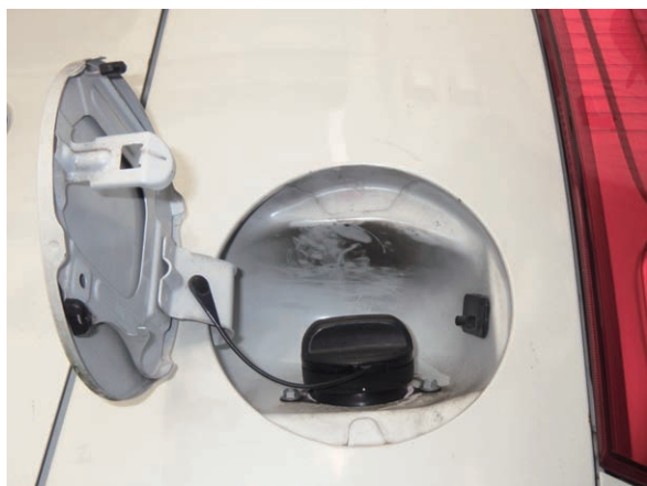
写真 29-4 給油口に付着した煤
