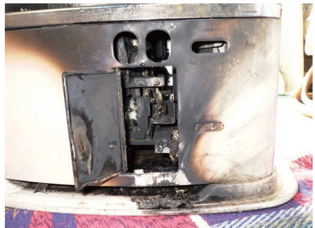
写真 8-2 操作扉内部の焼損状況
