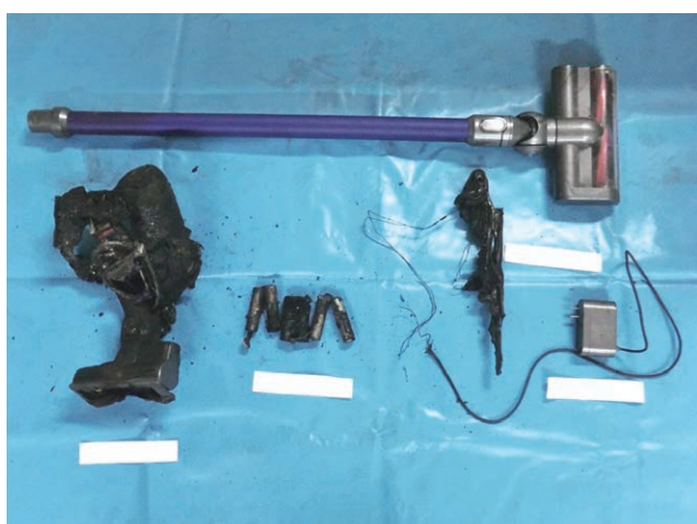
写真 6-3 焼損したコードレス掃除機の状況
