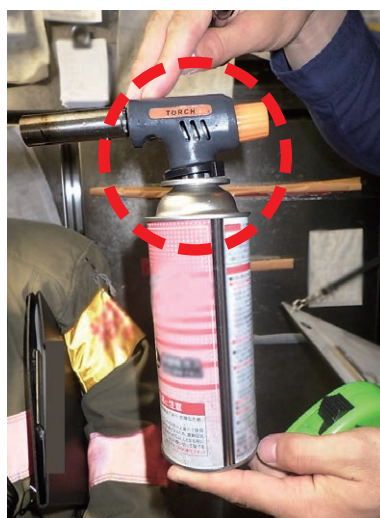
写真 11-4 ブタンガストーチバーナとカセットボンベの接続不良状況
