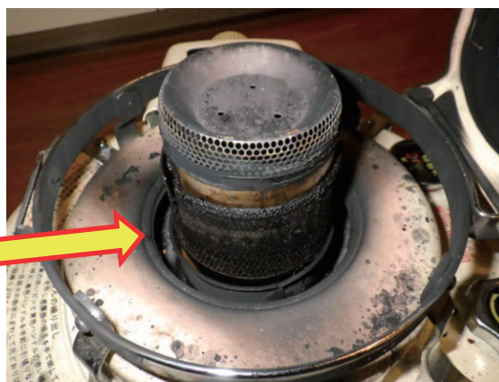
写真 8-4 燃焼部分の状況 (芯外筒がなく芯が見えている)
