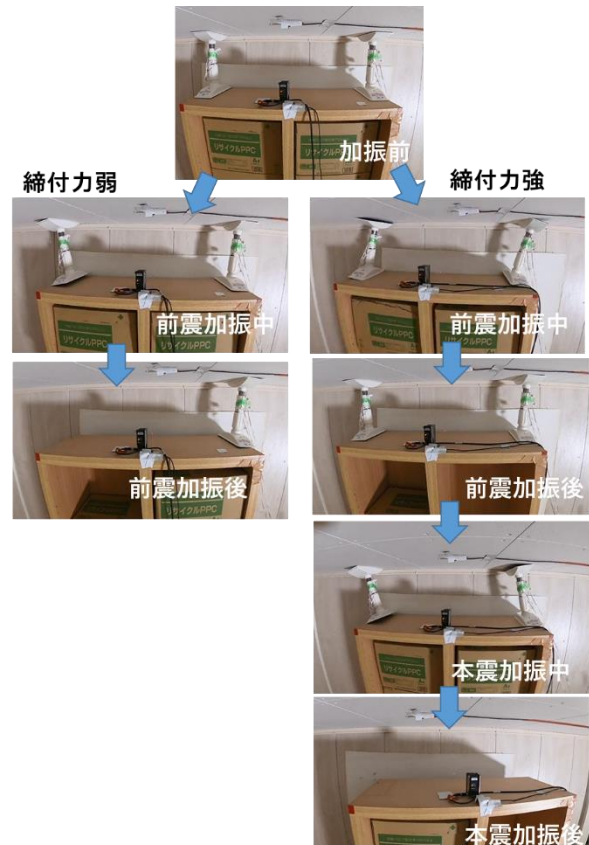
図17 熊本地震における防止器具の挙動
