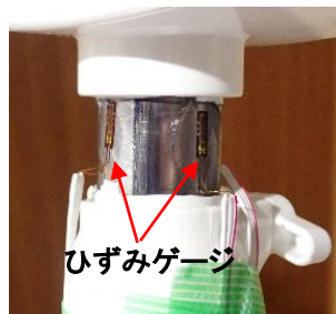
図5 ひずみゲージの貼付け
