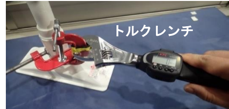
図6 突っ張り力調整ねじの締付のトルク測定
