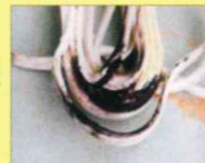
コードの電線 が熱で溶融
