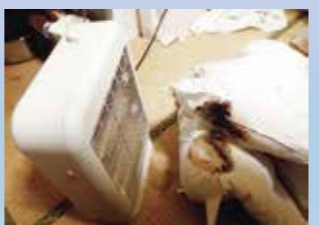
電気ストーブに布団が接触し焼損した状況
