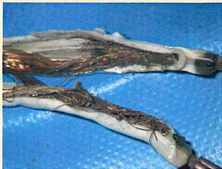
コードの電線が熱で溶融
