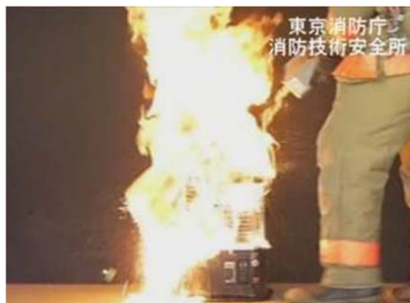
石油ストーブの火が 灯油に引火した状況
