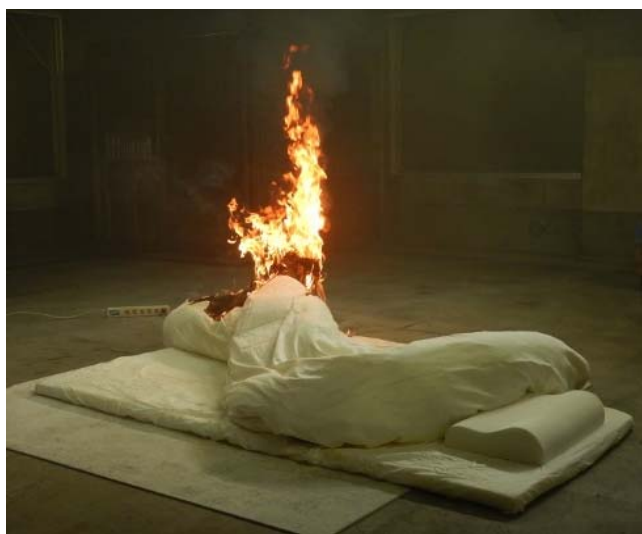
写真1 電気ストーブに布団が接触し出火した様子
