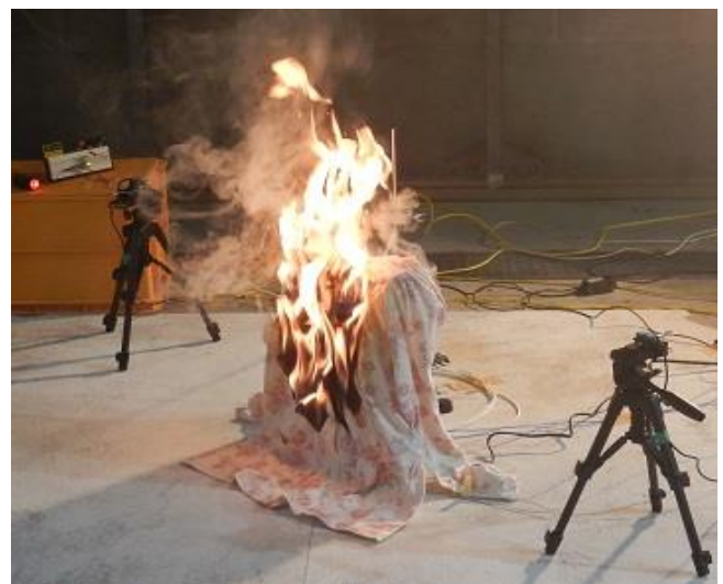
写真2 電気ストーブにパジャマが接触し出火した様子
