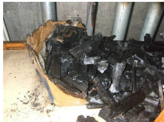
写真2 炭の焼損状況
