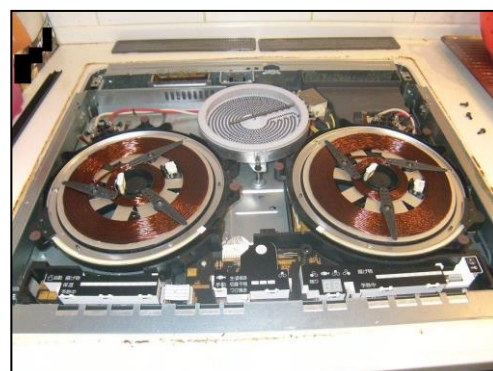
写真B IHクッキングヒータ （ガラストップを外したもの）
