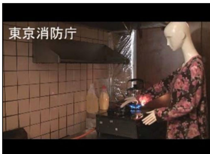
ガステーブル等による着衣着火の実験状況
